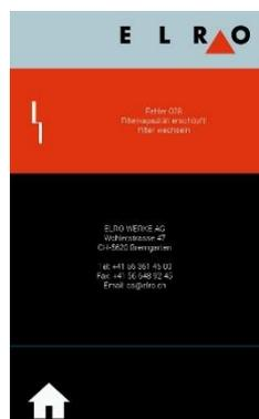
Falls Sie den Filter nicht wechseln und die Filterkapazität erschöpft ist, können Sie **KEINEN** Druckgarprozess starten.
