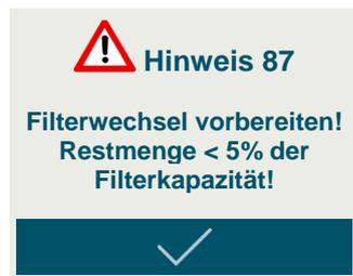
Vor dem Erreichen der Filterkapazität wird die Wartungsmeldung ausgegeben, dass der Filterwechsel vorbereitet werden muss.
