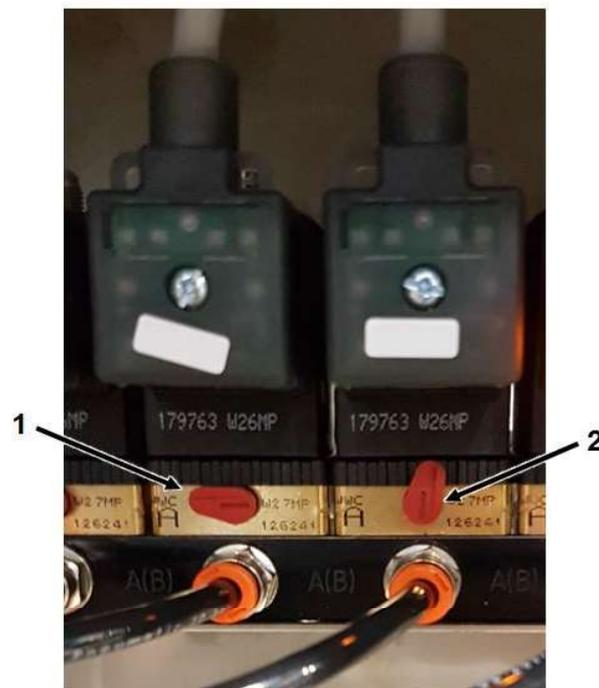
Abb. 0-149 Zwangssteuerung des Luftaktuator der Ventile
